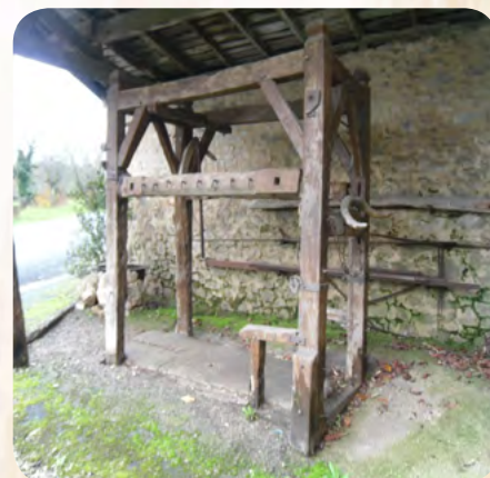
Ancien travail utilisé pour le ferrage des chevaux et le parage des vaches
